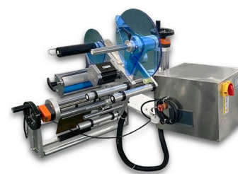
Автоматический встраиваемый этикетировщик HL-A450 (верхн. подача, W пленки до 450 мм) Hualian Machinery
